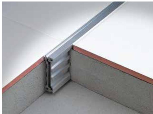
Juntas técnicas de dilatación en metal para la colocación con mortero deslizante. Ofrecen características de elevada resistencia a las cargas y de duración en el tiempo, asegurando siempre un agradable impacto visual. Compensan las dilataciones y contracciones de los suelos adyacentes gracias al deslizamiento de las dos partes metálicas una en la otra durante  $\pm 2$  mm. Perfil completo no ensamblado. Montar goma-espuma solo antes de la colocación.
